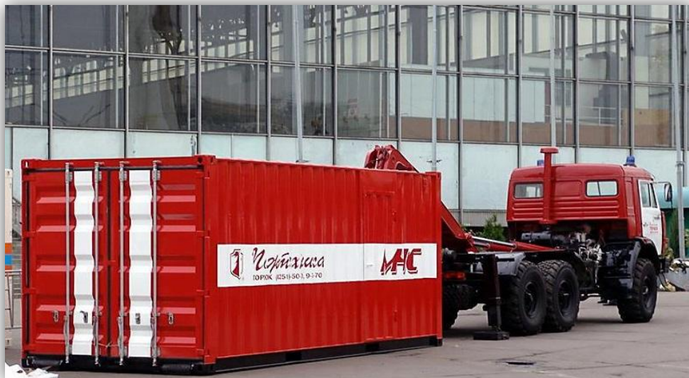
Рисунок 1. Автомобиль пожарно-спасательный контейнерного типа (АПСК)
